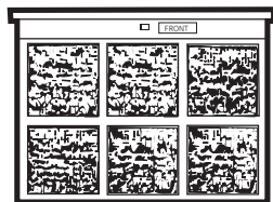
Filtre sale – Nécessite un nettoyage
