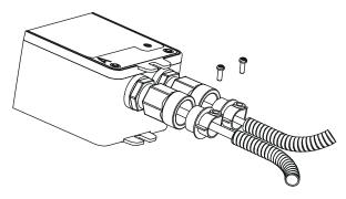
Figure 21: Adding Flexible Metal Conduit
